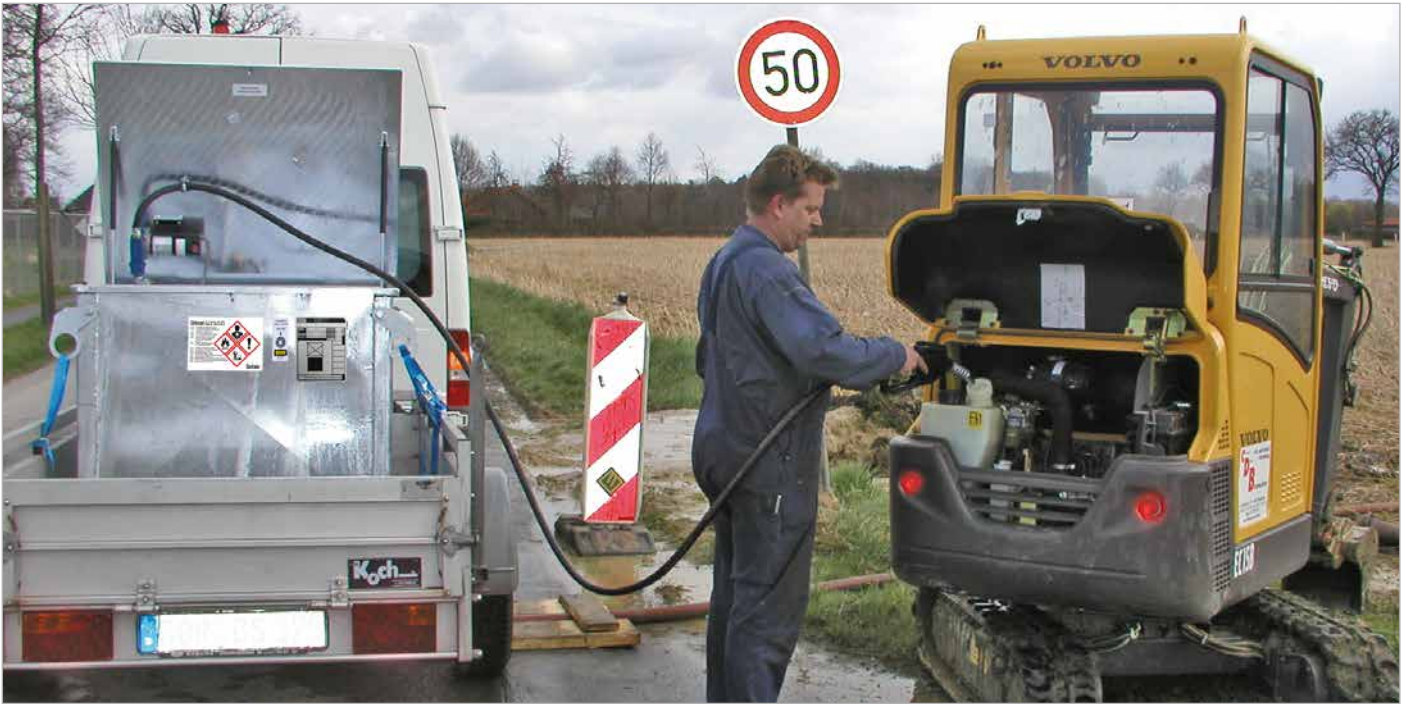
MT 450 mit Elektropumpe
