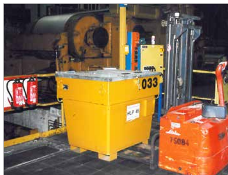
Mobile Öl-Versorgung von Maschinen
