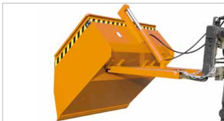
BSE hydraulische Ausführung (Sonderausführung)
