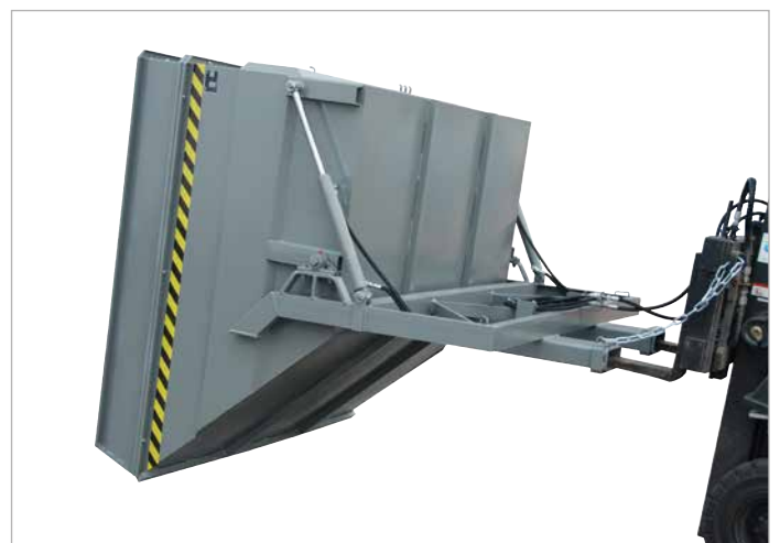
BKC-H (mit hydraulischer Kippvorrichtung)
