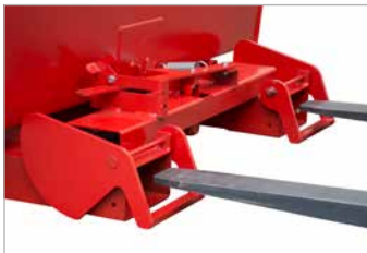
... Einfahren mit den Gabelzinken
