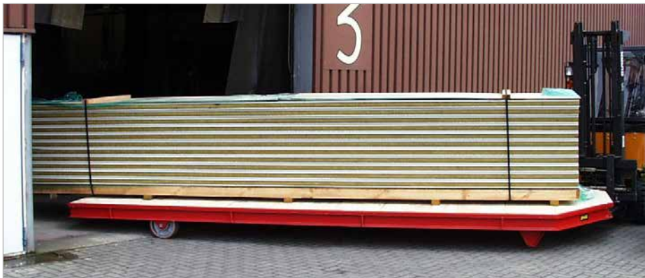
Transport von Langgütern; kleiner Wendekreis durch Direktaufnahme
