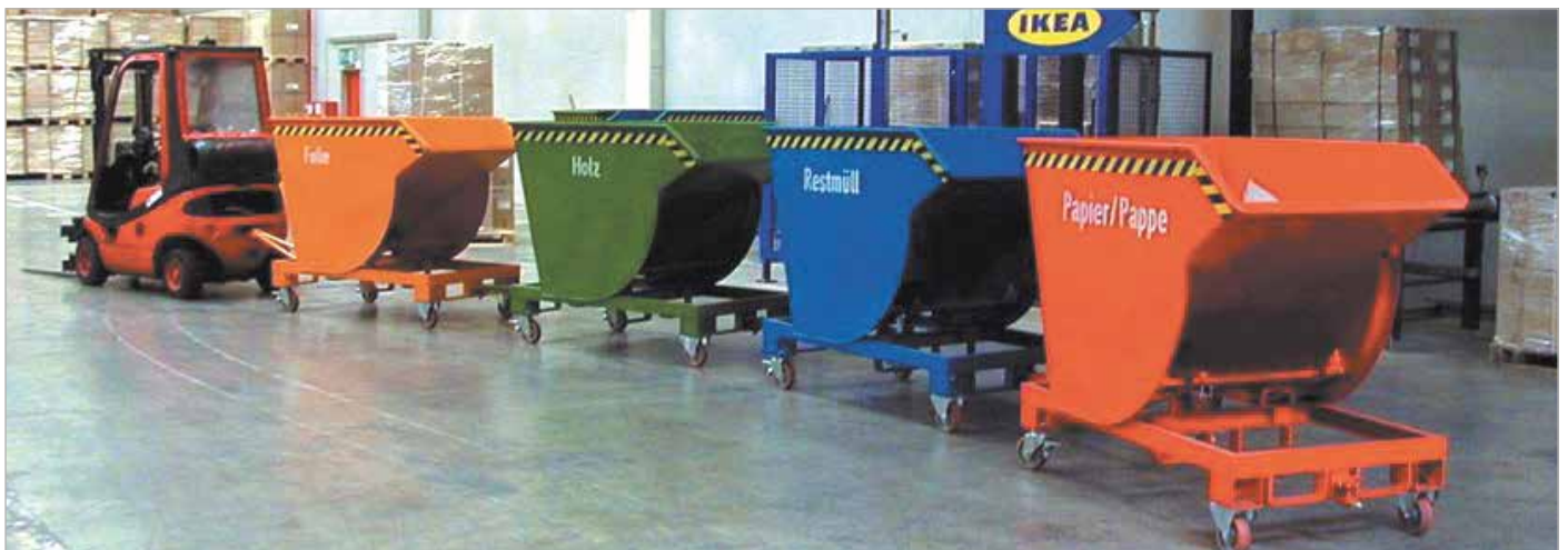
BKM mit Rollen und Anhängervorrichtung mit Deichsel
