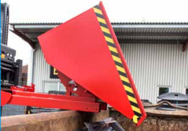
Abrollmechanismus mit automatischer Entriegelung
