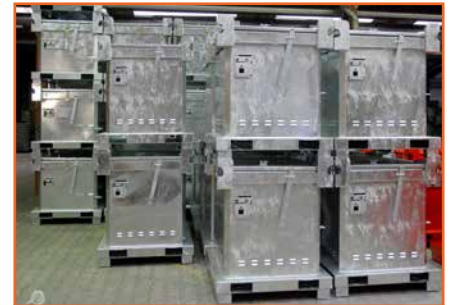
Sonderabfall-Behälter 150 (für Spraydosen)
