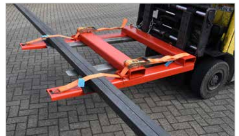
Aufnahmeposition zum Be- und Entladen
